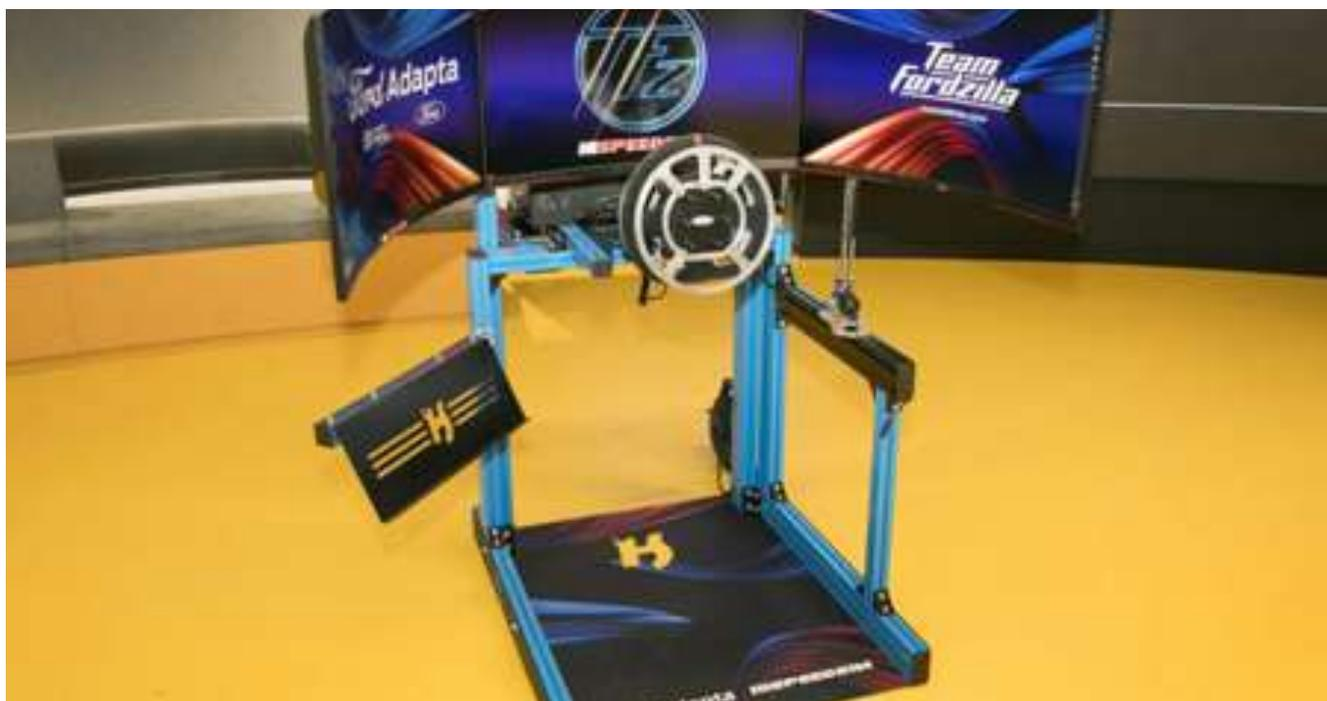
O simulador *Ford Adapta*, apresentado pela *Ford Espanha* em conjunto com a *Fundación ONCE*, é o primeiro simulador com um volante com aros, o mesmo utilizado nos veículos adaptados *Ford* na vida real. O simulador foi criado e adaptado para atender às necessidades de condutores reais e virtuais com mobilidade reduzida.
