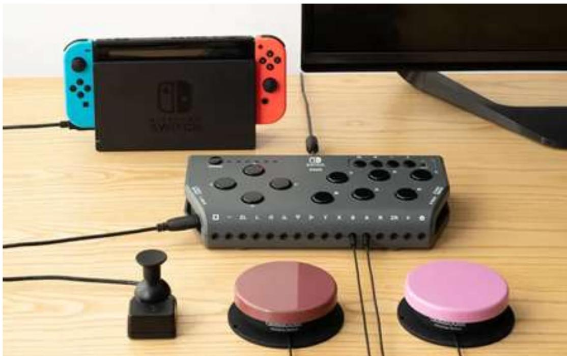
O *HORI Flex* é um comando do fabricante *HORI*, licenciado pela *Nintendo*, que permite conectar botões de assistência e *joysticks* adicionais (ambos vendidos separadamente) através de portas auxiliares e entradas USB. Isto permite aos utilizadores personalizar a configuração e a interface para satisfazer as suas necessidades individuais.
