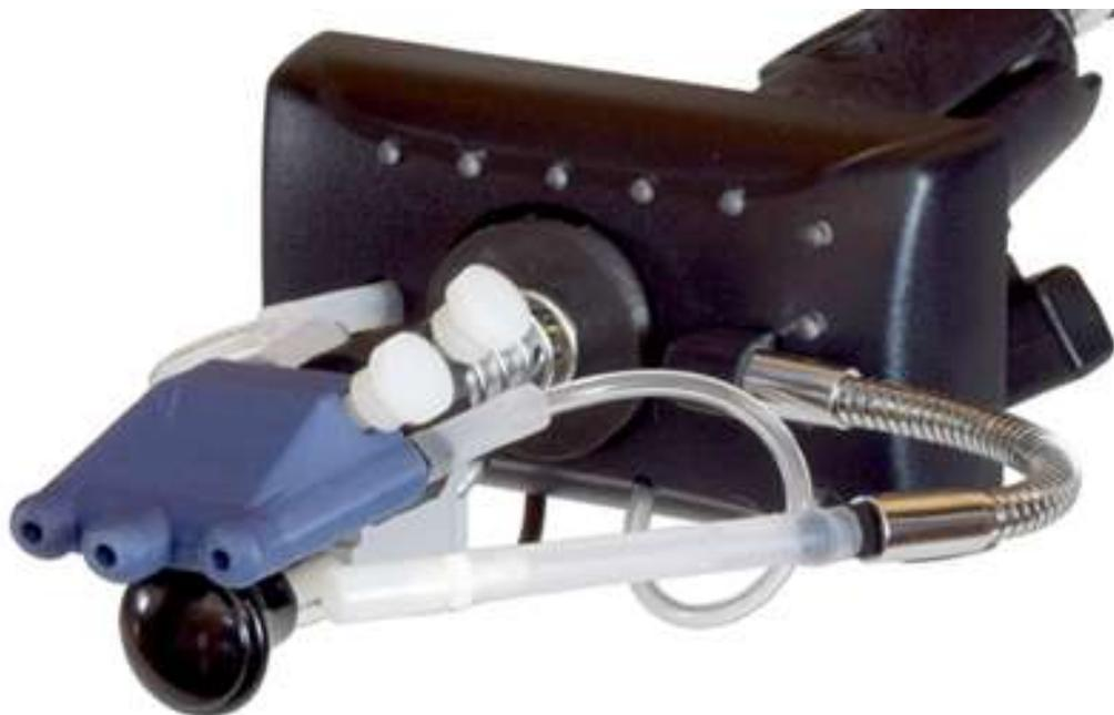
O *QuadStick* é um controlador de jogo USB compatível com *PS3*, *PS4*, *Nintendo Switch* e PC. Utiliza um módulo com um *joystick* grande e resistente para facilitar o controlo através do sopro e do movimento da zona do queixo. Atualmente, estão disponíveis 3 modelos distintos:
